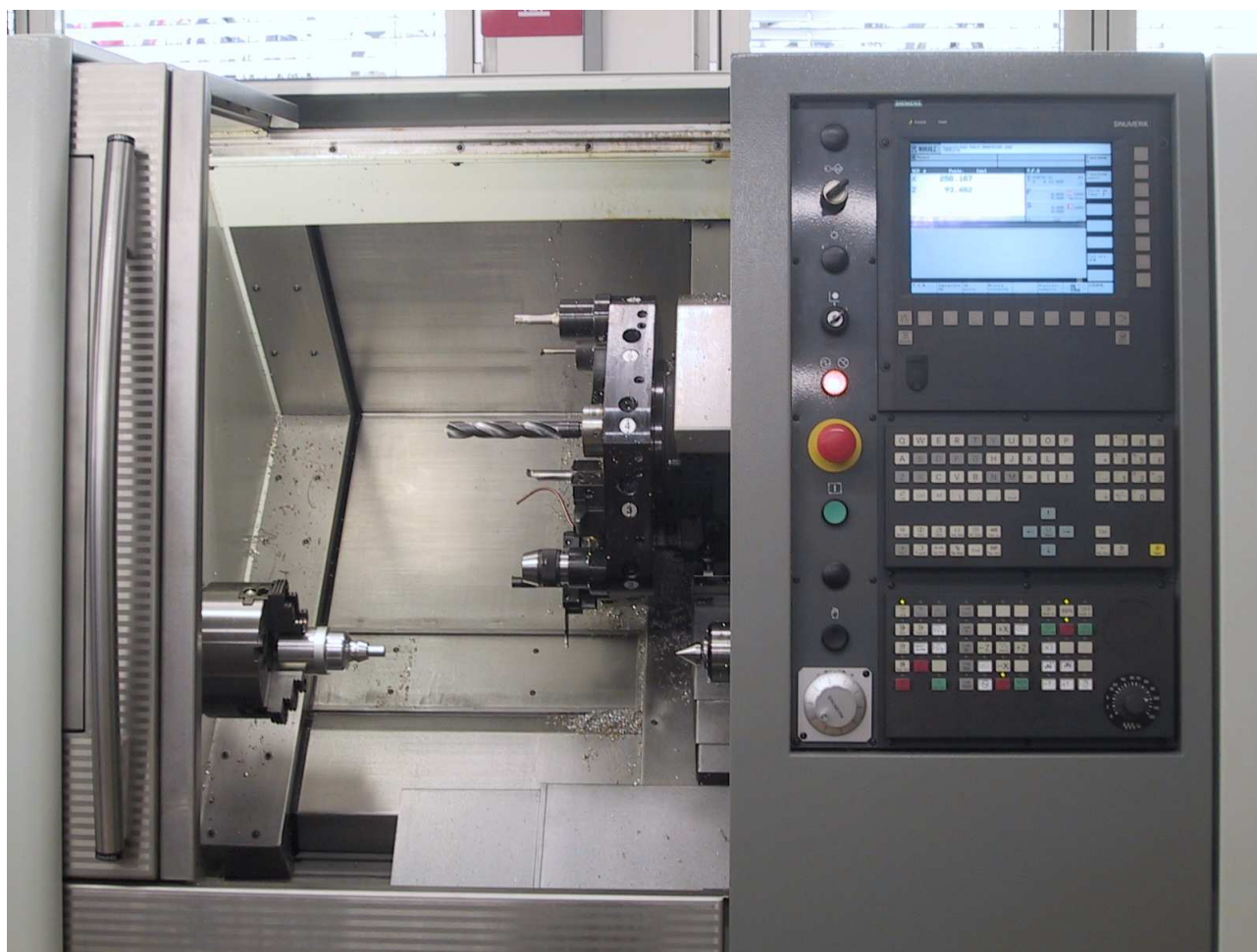
Figura 1. Tornio CNC Graziano CTX 310, Controllo Siemens 840D
